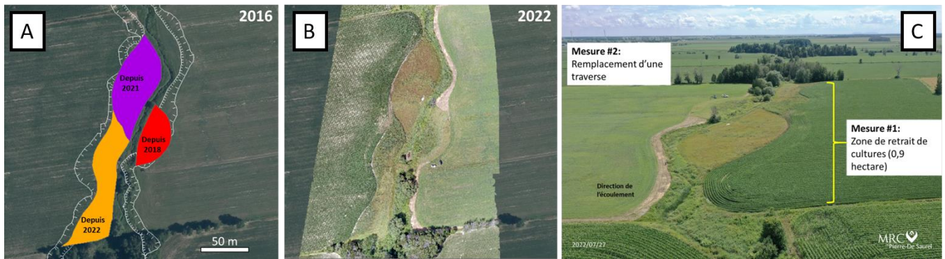
Figure 10 : Illustration du projet «Un méandre à la fois» montrant les mesures prises afin de restaurer un tronçon de cours d'eau en milieu agricole et de laisser un espace de liberté dans la plaine alluviale naturelle. A) Photo aérienne prise en 2016 montrant le retrait des cultures de la plaine alluviale historique de trois parcelles depuis trois années différentes : 2018, 2021 et 2022. B) Photo aérienne montrant le secteur de retrait des cultures en 2022. C) Vue aérienne par drone du site de restauration (juillet 2022) (crédit photo : MRC Pierre de Saurel) (Marchand et Marquis 2023).
